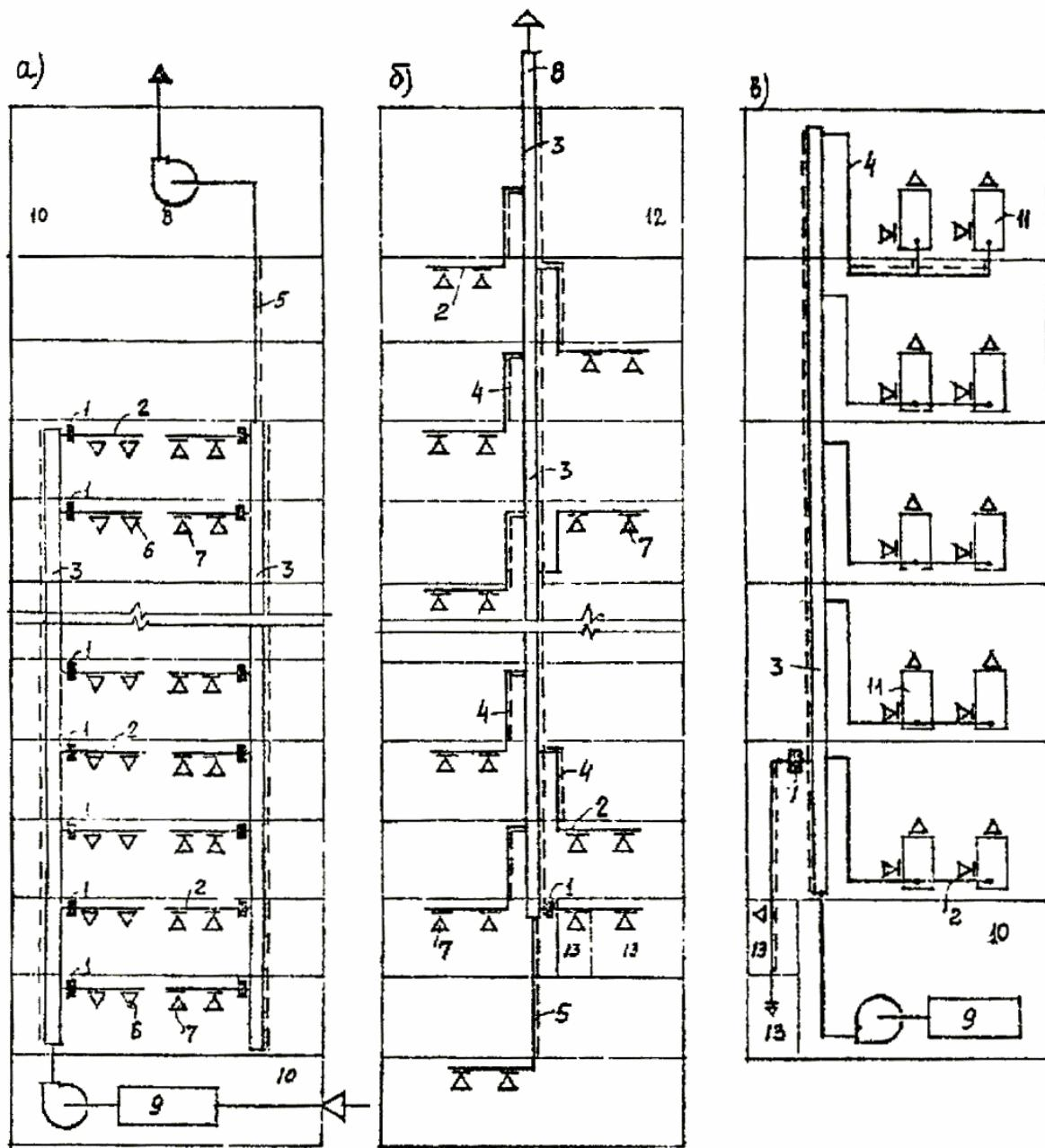
Рис. 1. Схемы воздуховодов с вертикальными коллекторами.
